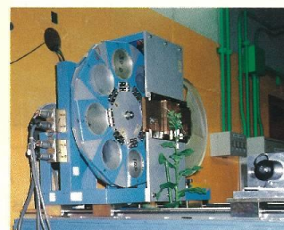
サイクロトロン生物照射室での実験の様子 写真の奥側から重粒子線の花の子房部分へ浴びせられる
